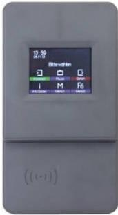
Wird das MasterIV-Gerät für die Zutrittskontrolle, Tür- bzw. Fernüberwachung eingesetzt, können mit einem Gerät bis zu 8 / 16 Türen überwacht und gesteuert werden.
