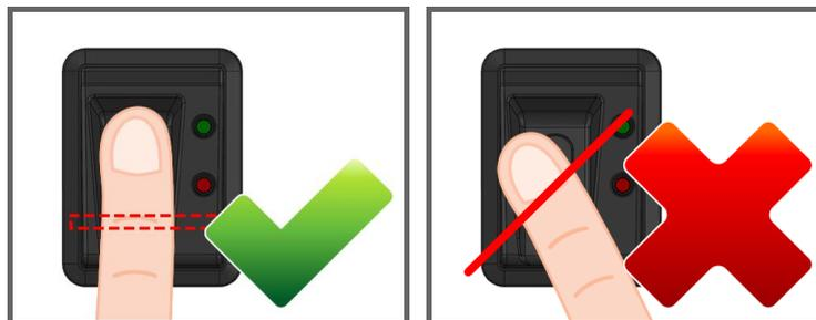
3.) Den Finger mit etwas Druck auf den Scanner flach über den Scanner ziehen.
