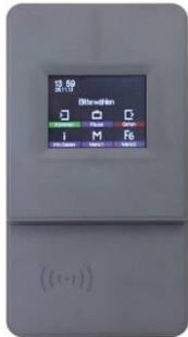
Das Datafox Gerät unterstützt die Türöffnung von bis zu 8 Türen.
