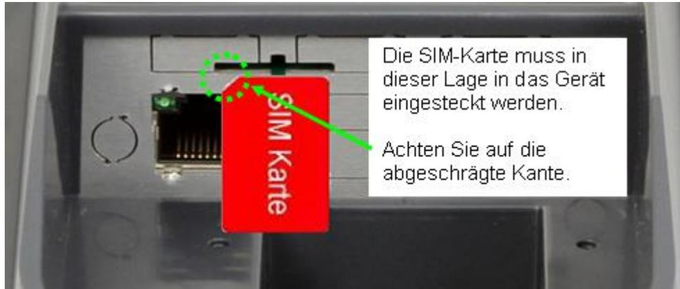
Die SIM-Karte muss in dieser Lage in das Gerät eingesteckt werden.
